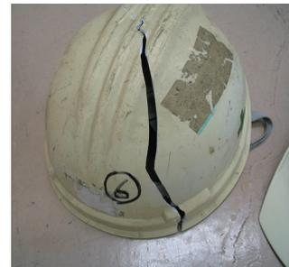
(写真はタニザワエコロジーセンターへ送られてきた使用済みヘルメットを使い、衝撃吸収性能試験をしたものです。)
